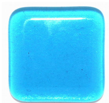
2 kerrosta, 6 mm ei muodonmuutosta, 1 pyörityneet kulmat
